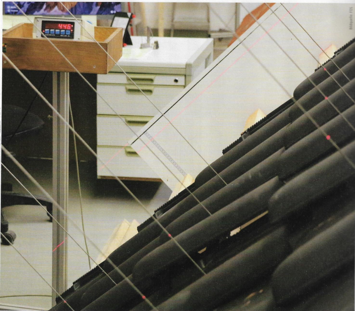
Im Labor wird der Windsog am Modell simuliert, um die passende Sturmklammer zu ermitteln.
