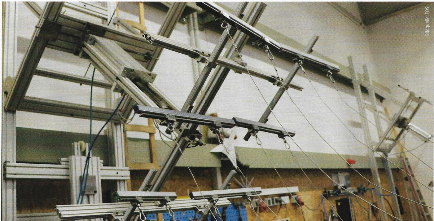
Der Windsog wird mittels Drähten simuliert, die mit den Ziegeln verbunden werden.
