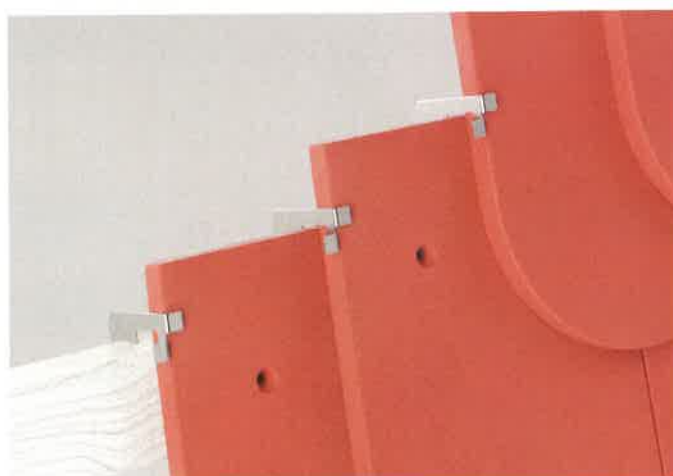
▲ Das Prinzip: Eine Klammer verankert je zwei benachbarte Ziegel an der Dachlatte. Die Klammer muss dafür auf Biber und Lattung abgestimmt sein
